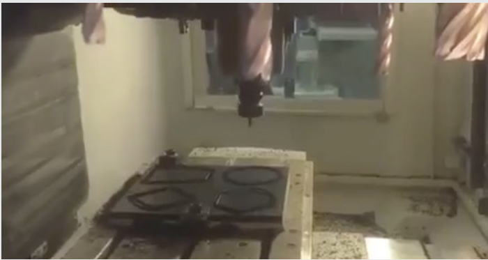
Figura 10. Mecanización de placa con rompecabezas. Fuente: Elaboración propia.
