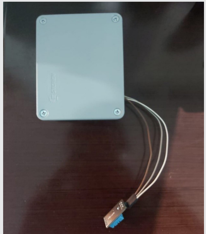
Figura 6. Exterior de módulo de monitoreo de temperatura.
